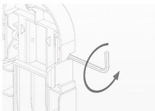
**- Encaixe o mordente para morsa de 5mm na ponta do parafuso.**
