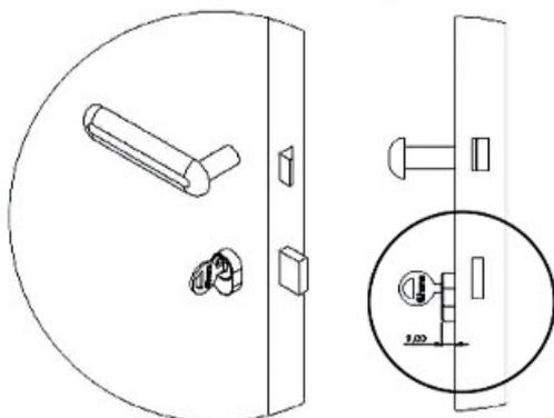
**Exemplo de fechadura sem a roseta** e que é possível realizar a instalação da Fechadura Inteligente.
