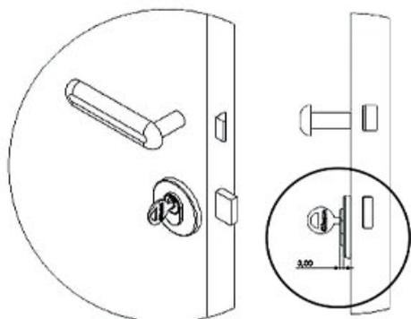
**Exemplo de fechadura com roseta** e que não é possível realizar a instalação da Fechadura Inteligente.
